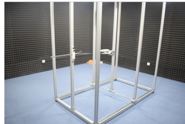
玩具消音室, 玩具的静音测试
